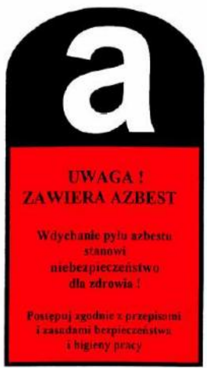
Rys. 2 Oznakowanie wyrobów i odpadów zawierających azbest, wysokość znaku powinna wynosić co najmniej 5 cm, a szerokość co najmniej 3 cm
